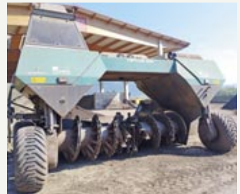
Mit diesen Umwendemaschinen werden die Mieten gewendet.
