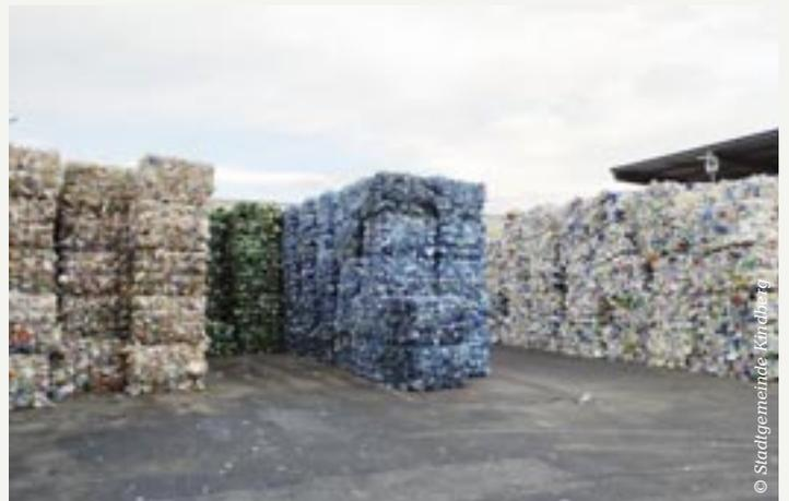
Diese fertig sortierten und gepressten Ballen wiegen rund 240 kg und umfassen rund 10.000 PET-Flaschen
